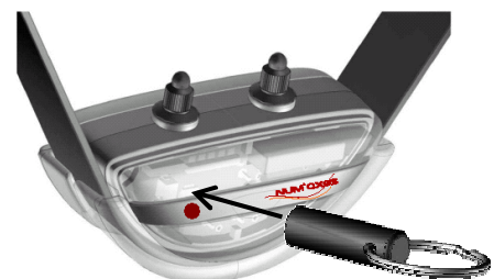
Abb. 5 Das Halsband mit dem Magnetschlüssel ein-/ausschalten
