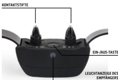
**EMPFÄNGERHALSBAND:** Empfängt das Funksignal vom Sender und gibt den statischen Reizimpuls, die Vibration und/oder ein Tonsignal zur Korrektur Ihres Hundes ab. Das Gerät ist wasserdicht und kann bis zu einer Tiefe von 7,6 m in Wasser getaucht werden.
