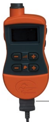
ANSCHLUSSSTECKER WIRD AM LADEANSCHLUSS DES HANDSENDERS ANGEBRACHT
