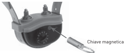
Fig. 3 Accensione/Spegnimento del collare con la chiave magnetica
